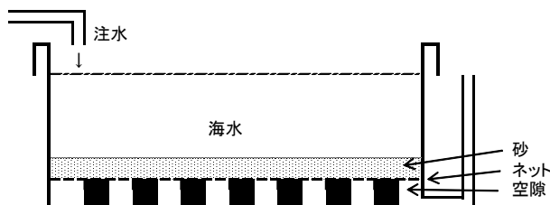
図1 親ガニ飼育水槽模式断面図
