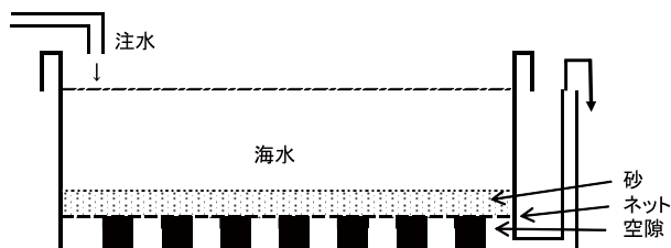
図1 親ガニ飼育水槽模式断面図
