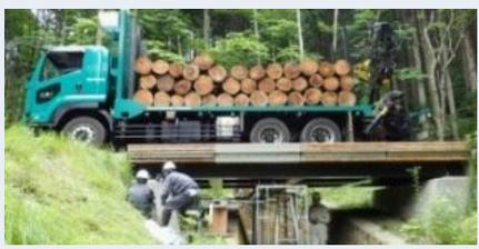
CLT床版の載荷試験  | (1)歩道橋床版・敷材<br>等の大型商品化      | (2)ラッピング技術等による耐久性強化<br>(3)実証施工・マニュアルの作成<br>※歩道橋、仮設橋等で事例蓄積            |                               | 土木分野<br>需要創出  |
