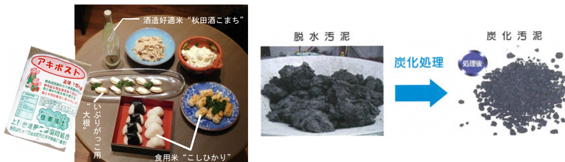
図 2-16 汚泥発酵肥料（コンポスト）として緑農地利用、下水汚泥の炭化製品化
