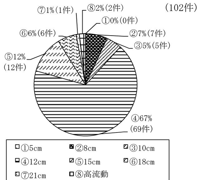
図-解 2-1 施工の際に変更した後の目標スランプの値
