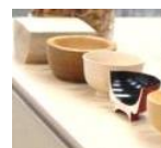
製品後の狂いが生じないよう、十分な乾燥時間を経て仕上げていく。
