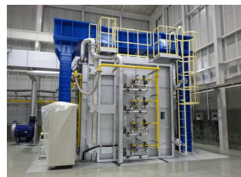
柱材の試験炉
