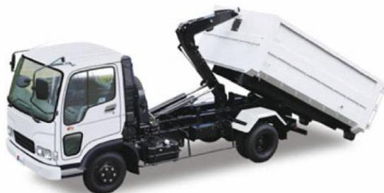
図2-5-4-3 脱着装置付コンテナ自動車
