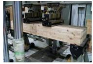
CLTの耐荷重試験
