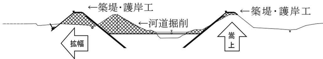
横断図 (築堤、護岸工、河道掘削イメージ)
