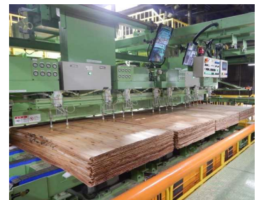
導入された施設の例 (合板単板乾燥機)
