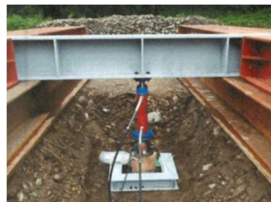
〔スギ丸太杭載荷試験の状況〕
