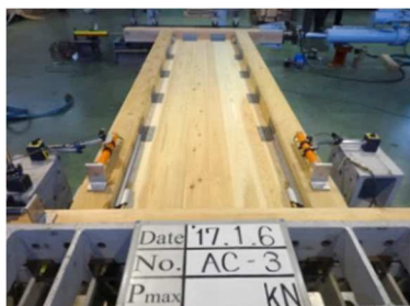
【C L T耐力壁の強度試験】
