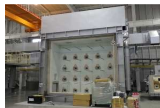
【壁材の試験炉】
