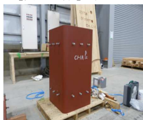
【柱となる角型鋼管にスギ集成材で被覆】
