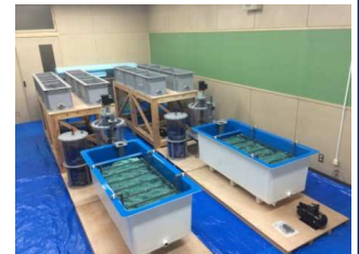
ファンド事業で開発した「閉鎖循環式アワビ養殖システム」 ENEX株式会社(美郷町)
