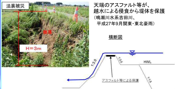
＜被害軽減を図るための堤防構造の工夫(対策例)＞
