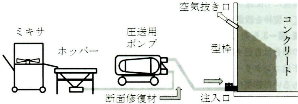
解説 図-3.6.4 充填工法の例
