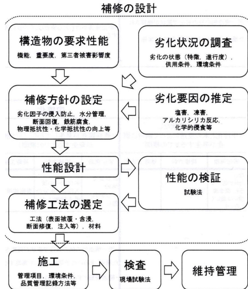
解説 図-2.4.1 補修工法検討の流れ
