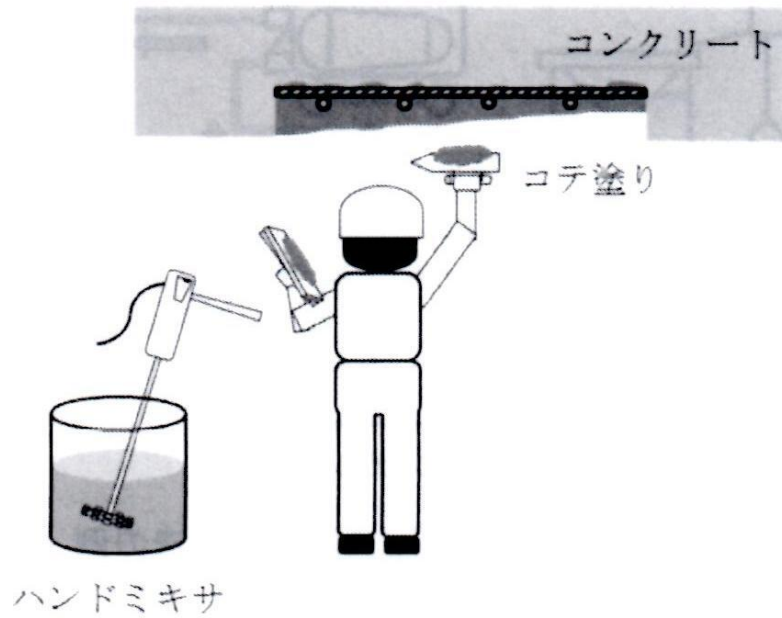
解説 図-3.6.1 左官工法の例
