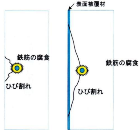
図 1-1 鉄筋腐食による表面被覆材の割れ
