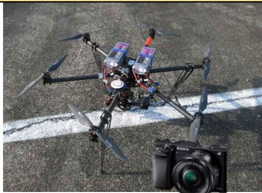
無人航空機を用いた 空中写真測量
