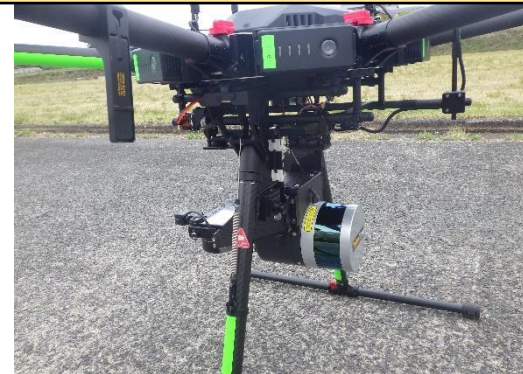
無人航空機搭載型 レーザースキャナー
