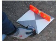
標高調整用基準点の一例
