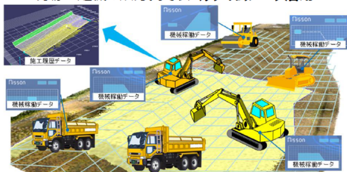
現場↔建機の双方向でリアルタイムデータ活用
