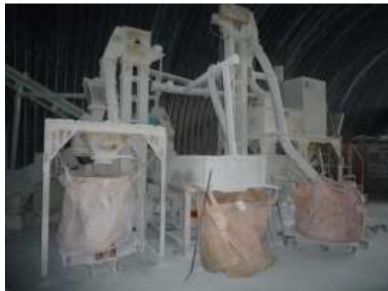
破砕処理装置（紙分離システム）
