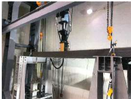
〔CLT橋梁用床版の試験〕
