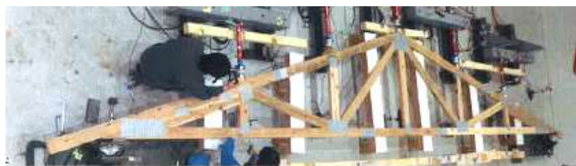
〔木造畜舎設計実証のためのトラス部材の性能検証〕
