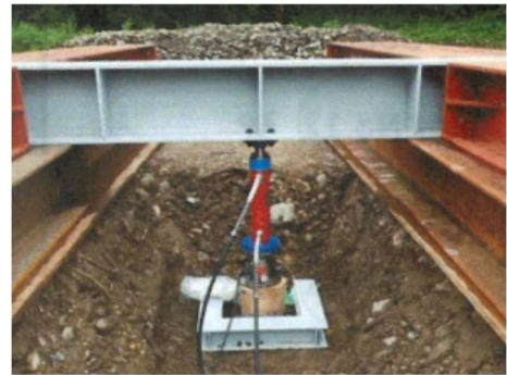
〔スギ丸太杭の載荷試験〕
