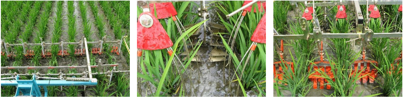
図1 けん引式水田用除草機による除草の状況 (左 田植機上から撮影, 中央 米輪+レーキ, 右 水田輪)
