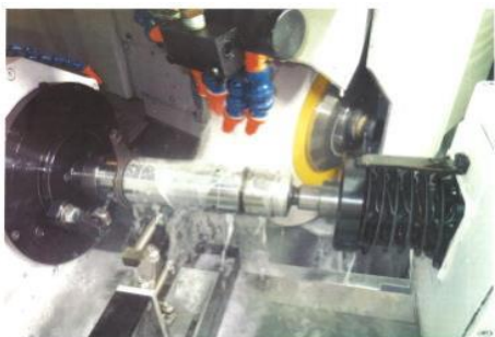
航空機ランディングギア部品の研磨工程
