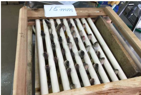
写真1 スリット幅の検討に用いた装置（予備試験）
