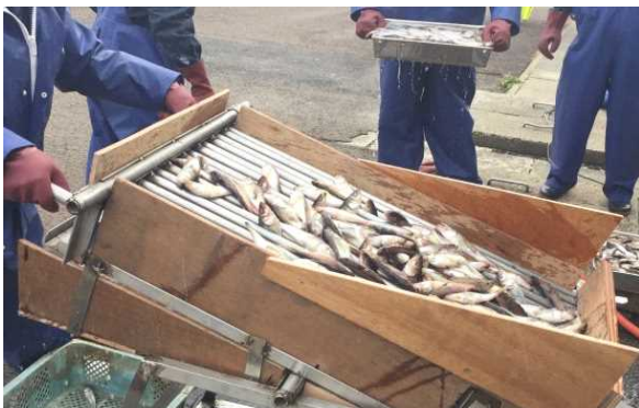
写真2-2 試作機によるスリット幅の試験
