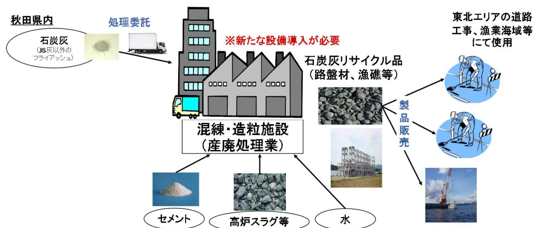
図 3-1 石炭灰リサイクル事業モデルケース①のスキーム図
