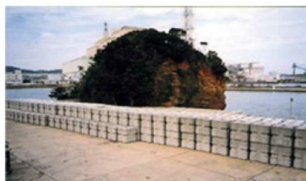
仮置きされたアッシュクリートブロック
