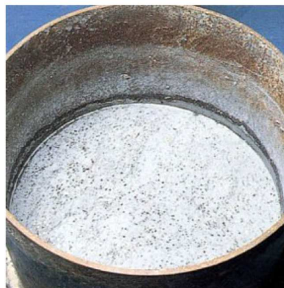
すべてが超流体化状態となる。表面もフラットになり、やがて水和反応による硬化が進む。
