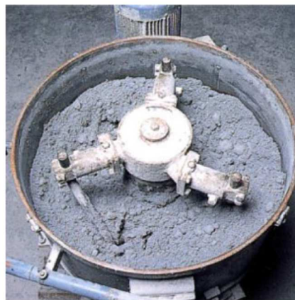
石炭灰、セメント、混和剤を混ぜた粉体に水を加え、ミキサーで混練する。この段階では粉体の状態が保たれる。
