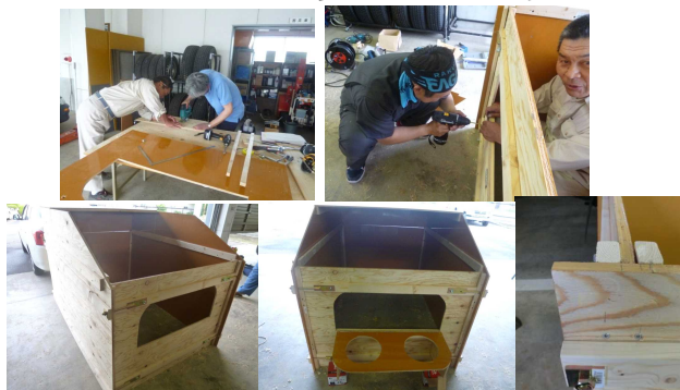
図-3 ハッチ試作 ～ウレタン塗装コンパネ製～
