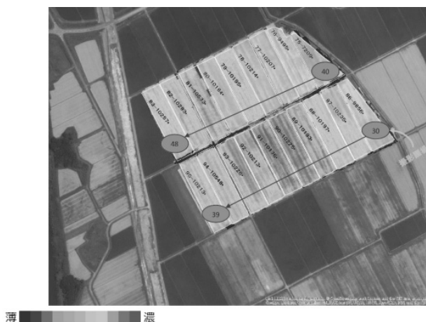
図－９ ドローンに搭載したマルチスペ クトルカメラにより撮影した NDVIマップ
