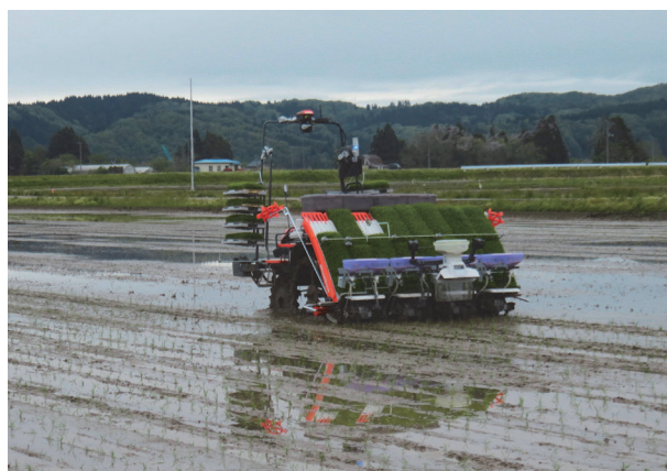
図－７ 無人田植機による作業
