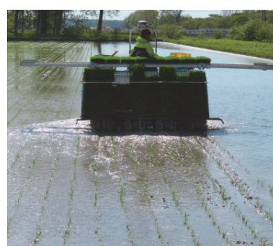
図－３ 自動操舵システムを活用した無落水田植の状況
