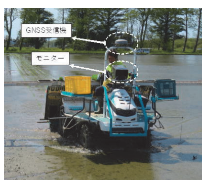
図－３ 自動操舵システムを活用した無落水田植の状況
