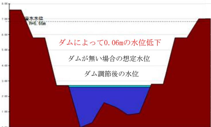
旭川ダムでは、7月7日の「梅雨前線による出水」のため、洪水調節を行いました。約95千m3の洪水をダムに貯留し、ダム下流の旭川に流れる水量を少なくしました。
