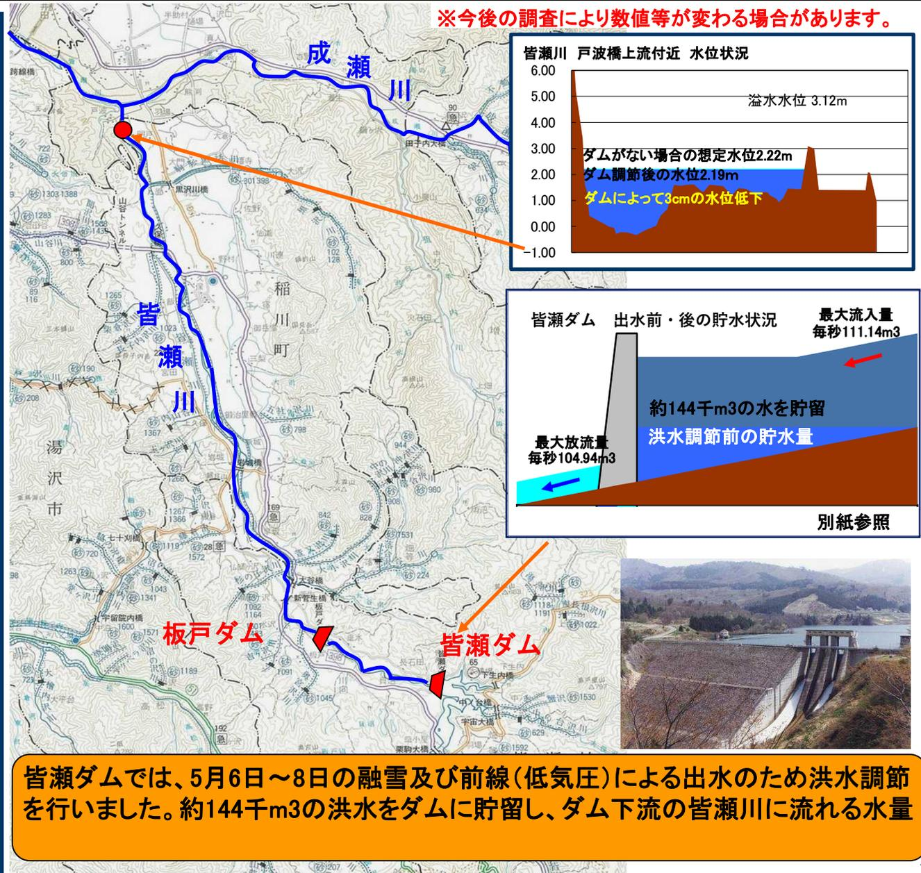
皆瀬ダムでは、5月6日～8日の融雪及び前線（低気圧）による出水のため洪水調節を行いました。約144千m<sup>3</sup>の洪水をダムに貯留し、ダム下流の皆瀬川に流れる水量
