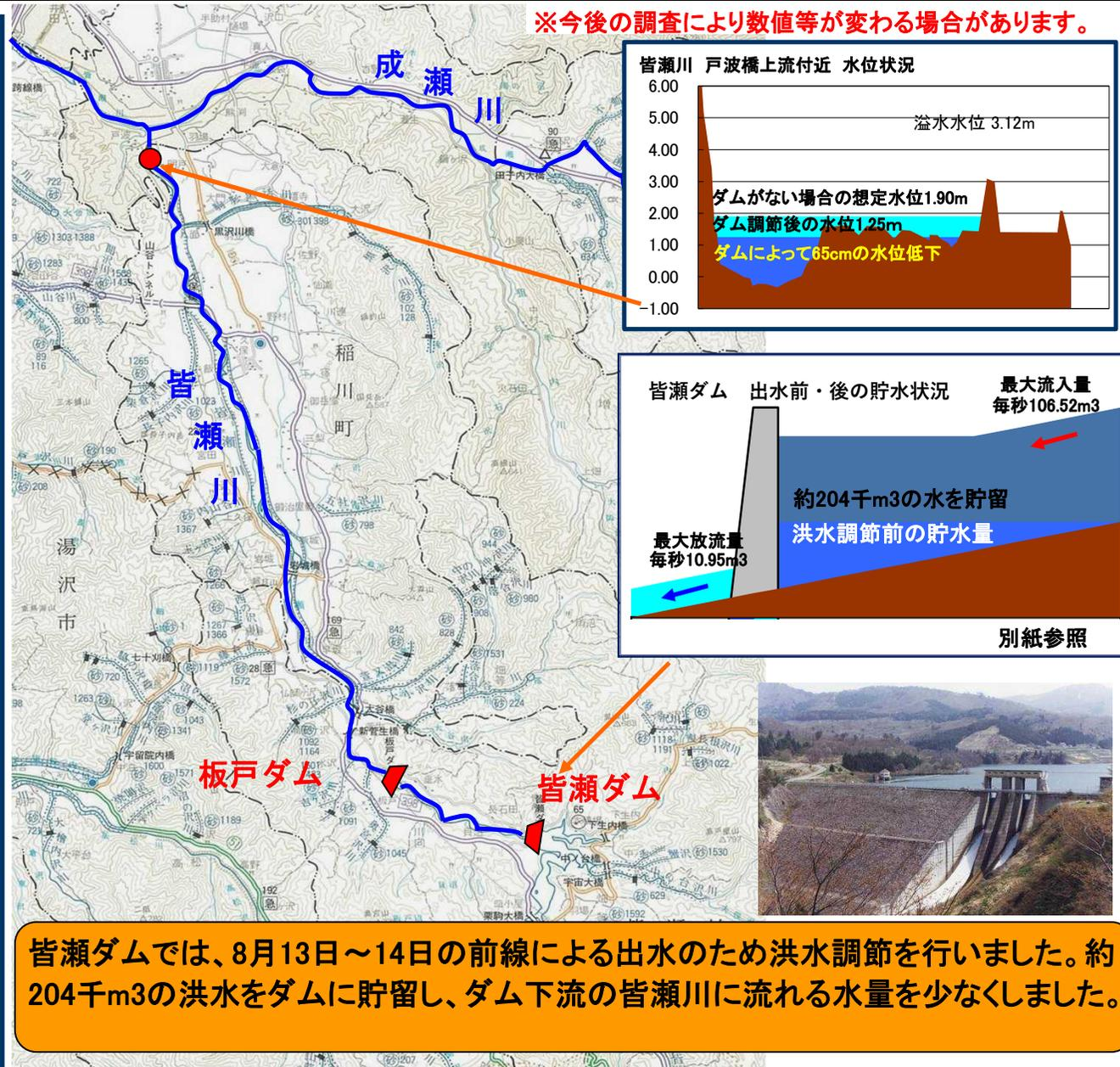
皆瀬ダムでは、8月13日～14日の前線による出水のため洪水調節を行いました。約204千m<sup>3</sup>の洪水をダムに貯留し、ダム下流の皆瀬川に流れる水量を少なくしました。
