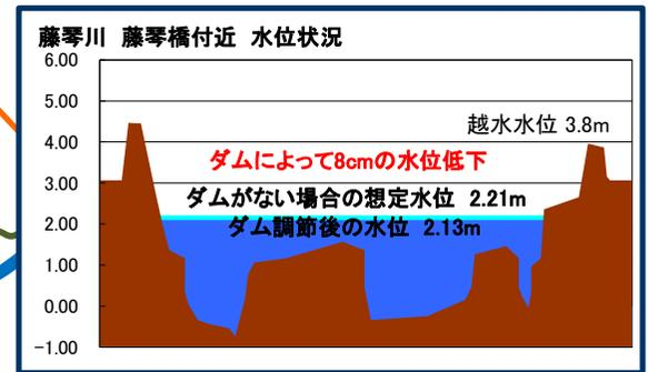
素波里ダムでは、6月28日、前線(低気圧)による出水のため、洪水調節を行いました。約895千m<sup>3</sup>の水をダムに貯留し、ダム下流の粕毛川・藤琴川に流れる水量を少なくして、洪水被害の軽減に努めました。
