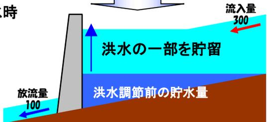
洪水時に、例えば300流れている水のうち200をダムに貯め、ダム下流には100だけ流します。
