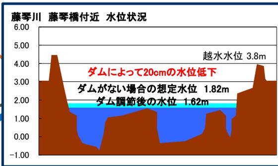
素波里ダムでは、3月27日、低気圧・融雪による出水のため、洪水調節を行いました。約3,544千m<sup>3</sup>の水をダムに貯留し、ダム下流の粕毛川・藤琴川に流れる水量を少なくして、洪水被害の軽減に努めました。
