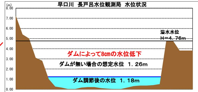
早口ダムでは、4月13日からの低気圧による出水のため洪水調節を行いました。約56千m³の洪水をダムに貯留し、ダム下流の早口川に流れる水量を少なくしました。
