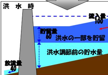
洪水時には、空容量を使って100流れてくる水をダムで60を貯めて、下流に40だけ流します。
