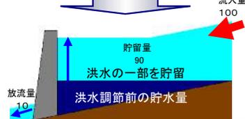
洪水時に、空き容量を使って100流れてくる水をダムで90を貯めて、下流に10だけ流します。
