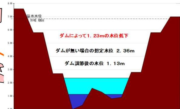
旭川ダムでは、9月4日の「前線(低気圧)による出水」のため、洪水調節を行いました。約96.66千m<sup>3</sup>の洪水をダムに貯留し、ダム下流の旭川に流れる水量を少なくしました。
