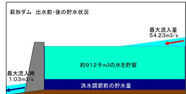
萩形ダムでは2月16日からの低気圧の影響による出水のため、洪水調節を行いました。2月16日16時から降り始めた雨は、最大時間雨量4mm、累計雨量は34mmとなり、最大流入量は54.23m³/sまで上昇しました。洪水調節量として39.35m³/s、約912千m³の水を貯留し、小阿仁川杉花水位観測局地点の河川水位を0.33m下げました。
