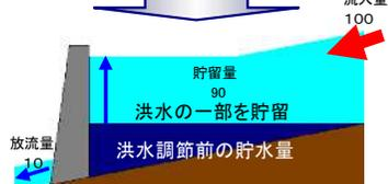
洪水時に、空き容量を使って100流れてくる水をダムで90を貯めて、下流に10だけ流します。
