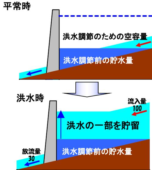
洪水時に、例えば100流れている水のうち70をダムに貯め、ダム下流には30だけ流します。
