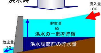
洪水時に、空き容量を使って100流れてくる水をダムで90を貯めて、下流に10だけ流します。
