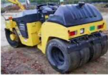
【締固め用機械】 ローラー（ロードローラー、タイヤローラー、振動ローラー） ※一般に認知されているハンドガイドローラーは移動用エンジンにより自走可能であり、ロードローラーの一種であるため、加点対象ですが、コンパクタやランマー等明確に自走能力がない建設機械は特定機械特定自主点検の対象ではないため、評価の対象にはなりません。
