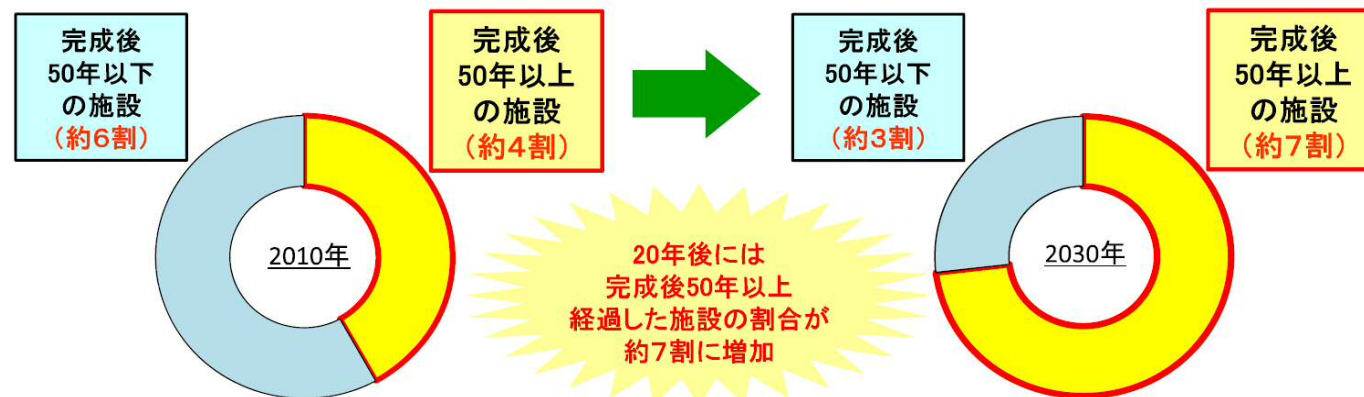
<海岸堤防等の老朽化の現状>
