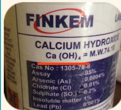
に見られる水酸化カルシウムの化学式、 $\text{Ca}(\text{OH})_4$ と書かれています。正しくは **$\text{Ca}(\text{OH})_2$** です。珍しい物質ではなく、むしろ強い塩基性物質としてテストにも頻出する物質。実験
