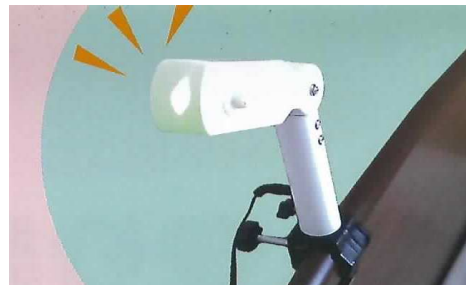
電子機器設計会社が開発した離床時の転倒・転落事故防止センサー
