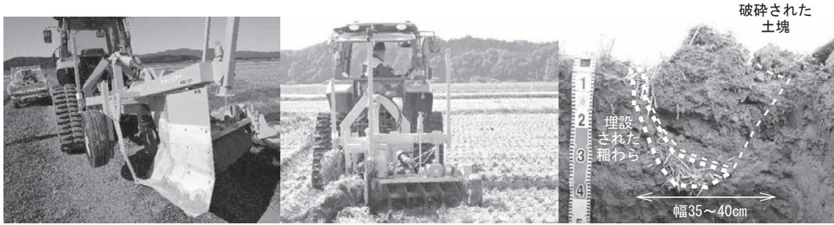
図-1 有材補助暗渠施工機カットソイラーと形成された補助暗渠の土壌断面
