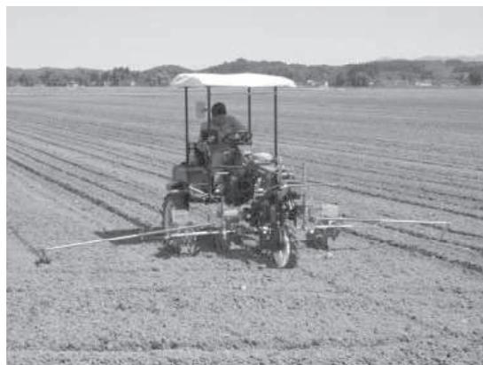
写真 ミッドマウント型管理作業車による播種作業
