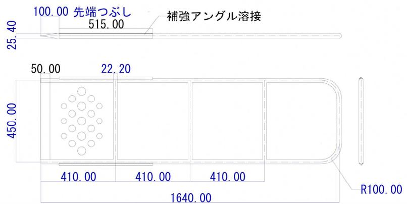
図2 沈降力破断器の仕様
