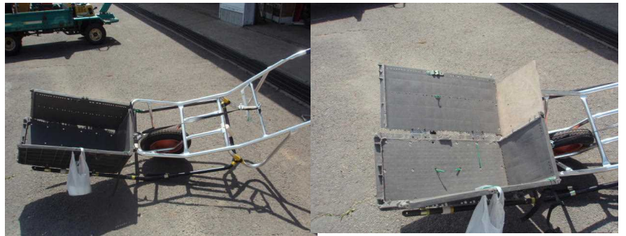
図2 収集作業補助器2号 一輪車に収集補助器1号を装着したもので、側面を開いて剪定枝を投げ入れ、側面を起こして結束する。
