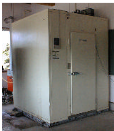
水分の蒸発を防ぎ庫内湿度を 写真1 ロック低温貯蔵庫 (庫内有効容積 4.7 m 3 )
