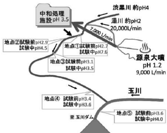
図 85 玉川ダムに至る強酸性水の流れと中和による pH 改善
