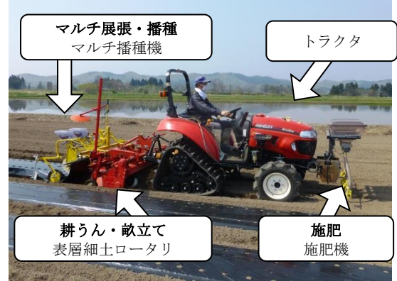
図 1 慣行播種作業と改良播種作業の作業状況(2013年、現地農家ほ場)
